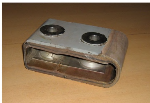
Рис. 4.9 Стыковой болтовой узел крепления лопасти НВ: 1-гайка, 2- штифт стопорный, 3- втулка, 4- шайба, 5- пластина металлическая, 6- втулка распорная.
