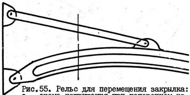
Рис.55. Рельс для перемещения закрылка:
