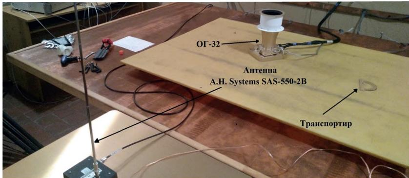
Рис. 13. Оптическая головка ОГ-32 при измерении индикаторы излучения
