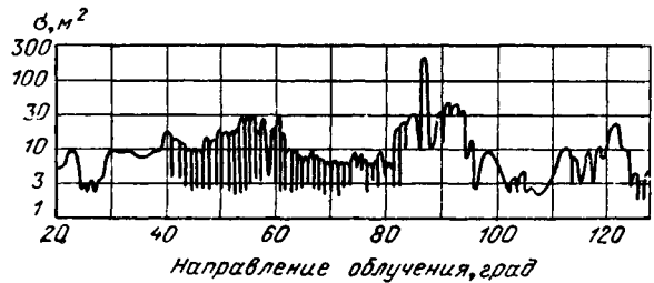
Рис. 2.22. Зависимость эффективной поверхности второго советского искусственного спутника Земли от направления облучения
