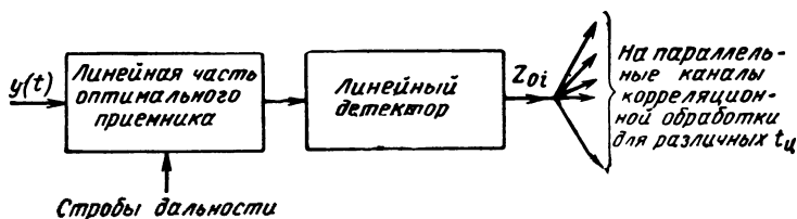
Рис. 5.45. Схема оптимальной обработки радиоимпульсов некогерентной пачки
