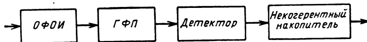
Рис. 7.17. Схема оптимальной обработки сигнала на фоне небелого шума при неизвестной скорости цели
