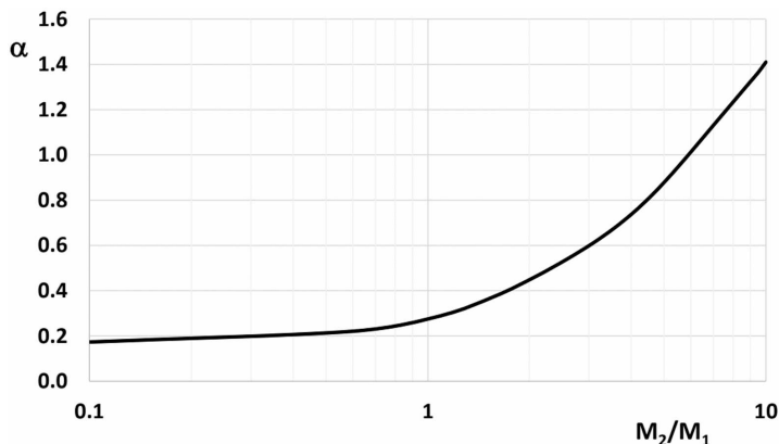
Рис. 1.6. Зависимость коэффициента \alpha от отношения масс мишени ( M_2 ) и иона ( M_1 ) при нормальном падении ионов
