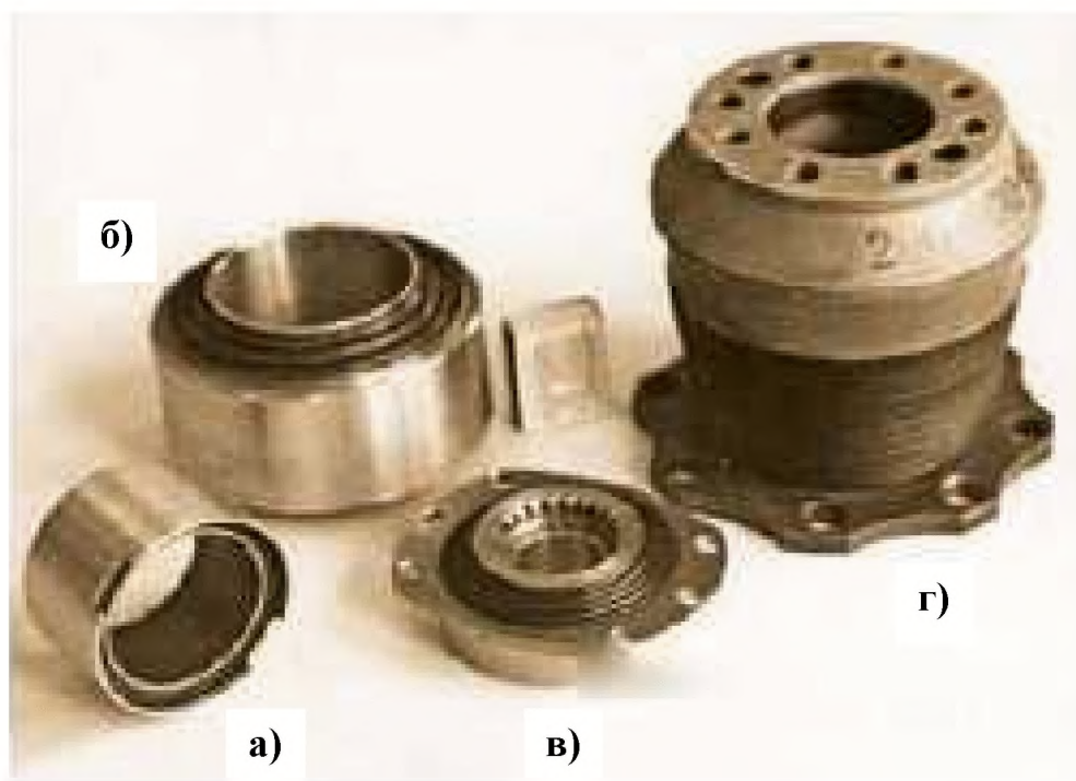
Рис. 3.25 Типы эластомерных подшипников: а- радиальный цилиндрический, б- конический, в- упорный, г- сферический.
