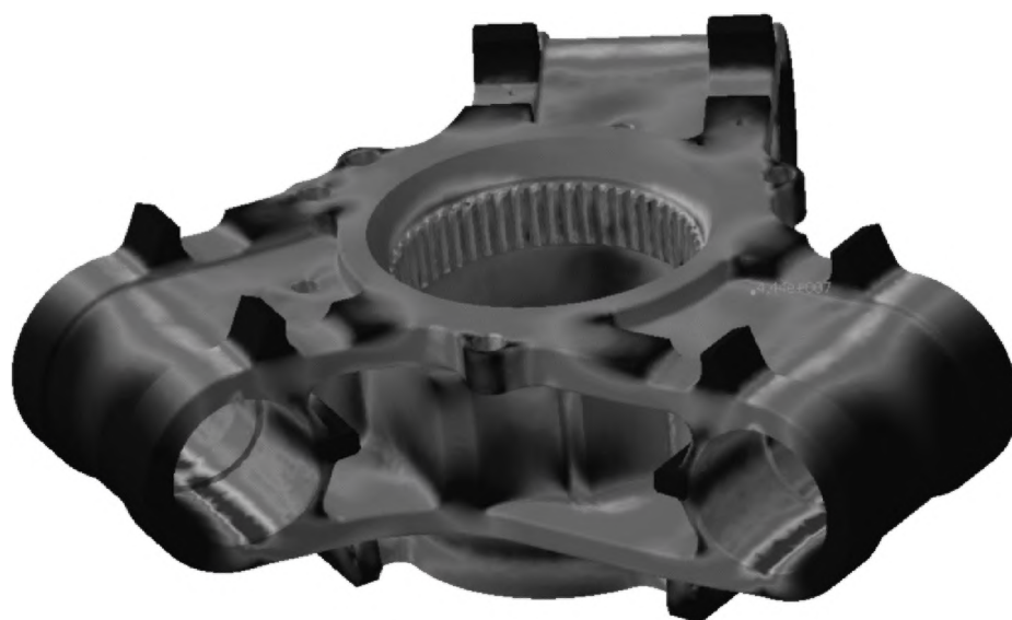
Рис. 4.3 Корпус ступицы втулки НВ соосного вертолета Ка-26.
