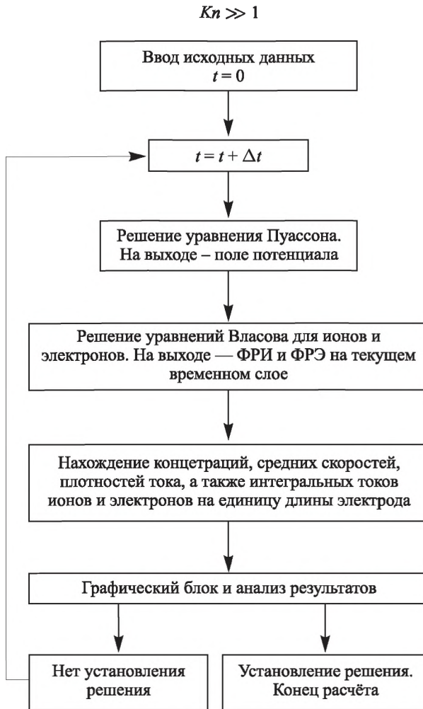
Рис. I.3.5. Блок-схема алгоритма метода последовательных итераций по времени
