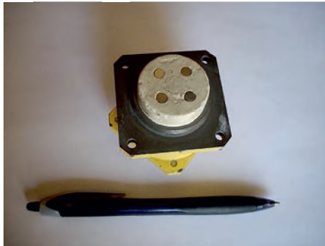
Рис. II.1.3. Фотография блока с пристеночными плоскими зондами
