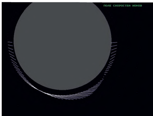
Рис. П.3.10. Скорость ионов по обводу цилиндра ( r_p = 3r_D , \varphi_0 = -45 , M = 0,5 , Re_3 = 200 )
