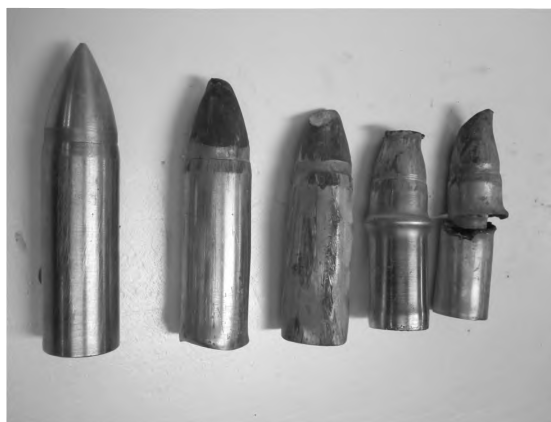
Рис. 5. Виды деформирования ударников после остановки в улавливающем устройстве
