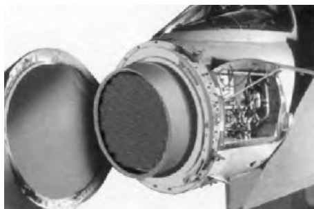
Рис. 1. Общий вид БРЛС CAESAR для РИ «Тайфун» (европейская разработка: Великобритания, Германия, Италия, Испания)
