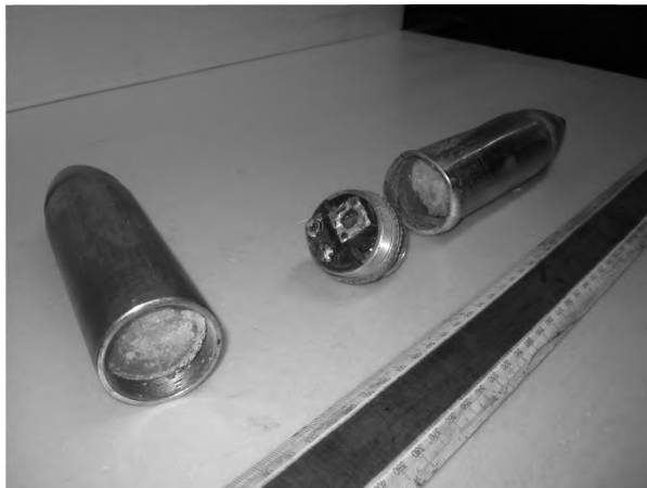
Рис. 4. Состояние ударника до (слева) и после проведения опыта. В центре – измерительный узел на основании (после проведения опыта)
