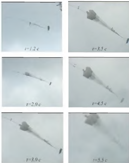
Рисунок 6 – Процесс наполнения ПС МКС-350-П260М при отказе семи из четырнадцати ТП; режим десантирования: V_{\text{пр. дес}} = 350 км/ч, H_{\text{абс. дес}} = 600 м
