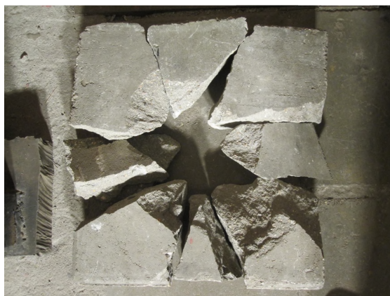
Рис. 3. Состояние бетонной мишени после проведения опыта
