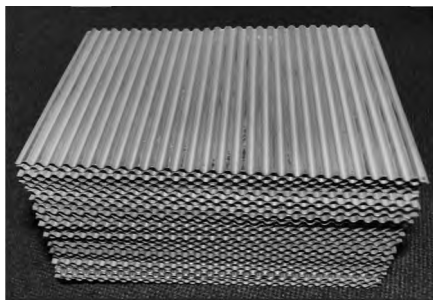
Рис. 2. Сотовый блок кубической формы
