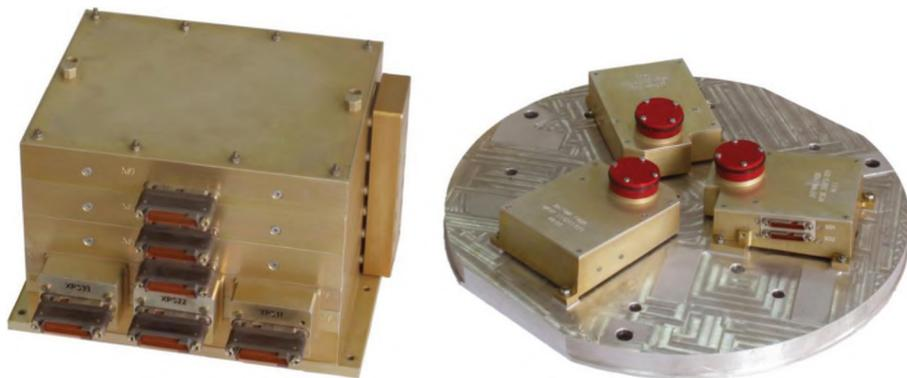
Рис. 1. Технологический образец СДГ: блок обработки данных и три датчика гида, установленные на имитаторе посадочного места
