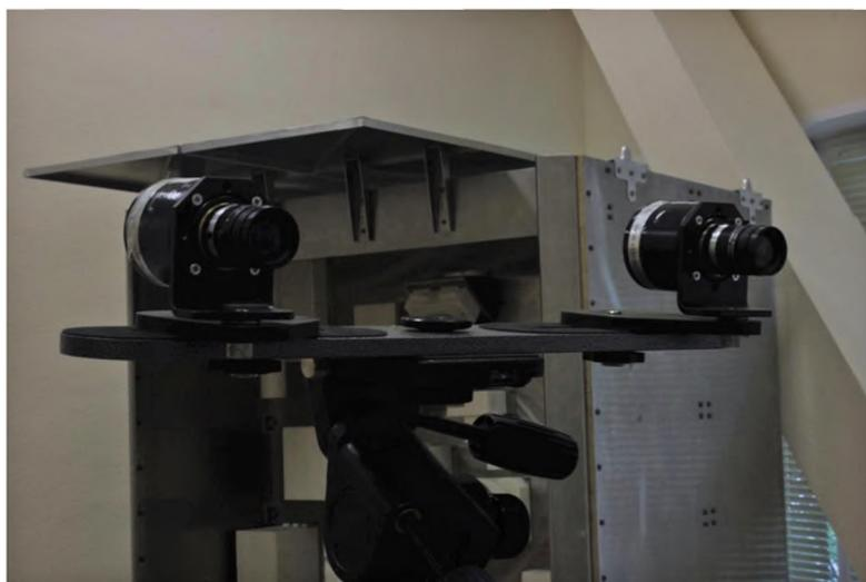
Рис. 5. Макет стереокамер
