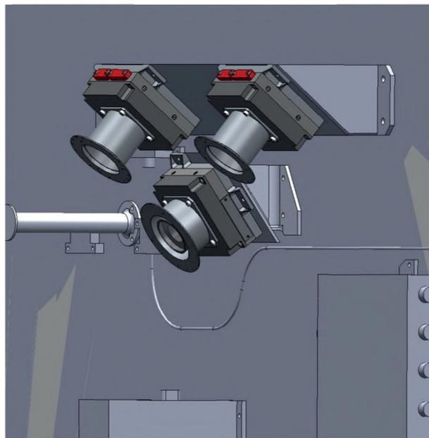
**Рис. 2.** Размещение стереокамер СТС-Л в приборном отсеке
