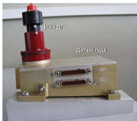
Рис. 4. Датчик гида с установленным ИЗН-ДГ
