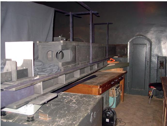
Рис. 2. Внешний вид коллиматора для стенда исследования бленд
