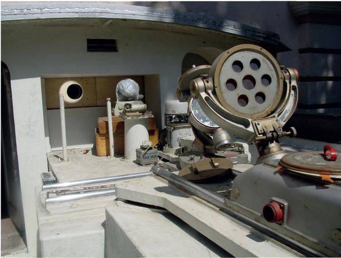
Рис. 1. Целостат горизонтального солнечного телескопа ГАИШ
