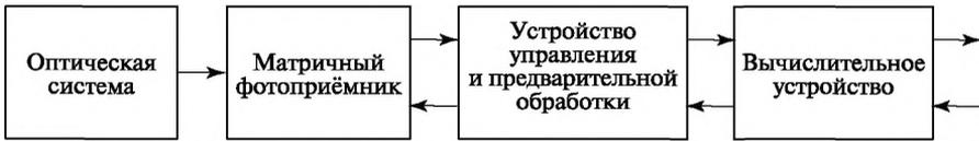
Структурно-функциональная схема звёздного прибора
