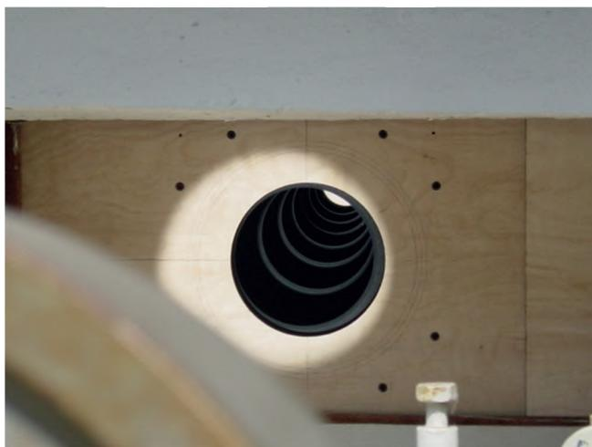
Рис. 3. Диафрагмы коллиматора. Вид со стороны целостата
