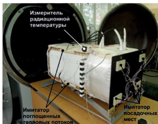
Рис. 6. СНИН-Х1-МВН перед установкой в термовакуумную камеру
