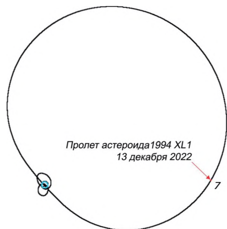
Рис. 5. Траектория аппарата в эклиптической инерциальной системе координат с центром в Земле с указанием точки пролёта астероида
