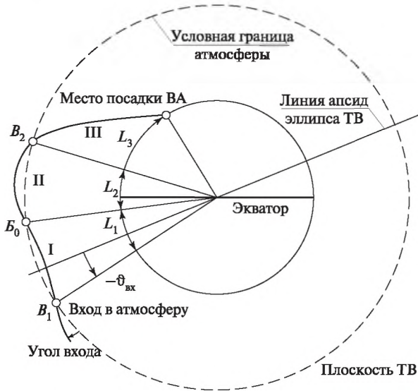
Рис. 2. Схема рикошетирующей траектории атмосферного торможения ВА. Важный пример: V_{\text{вх}} = 11 км/с, \vartheta_{\text{вх}} = -5,29^\circ , L_1 = 1900 км, L_2 = 5740 км, L_3 = 1960 км, L_\Sigma = 9600 км
