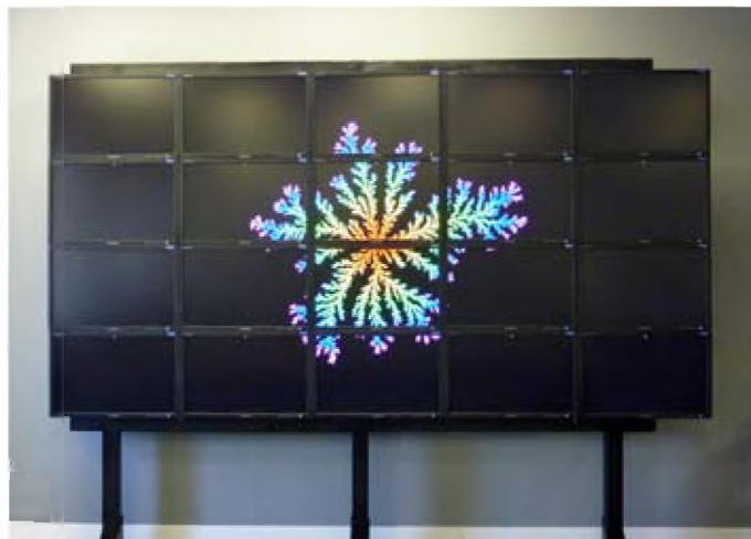
Рис. 4. Визуализация результатов численного моделирования двумерных структур роста с использованием технологии SAGE на видео-стене с разрешением 46 Мпикс.
