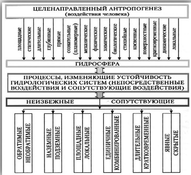
Рис. 6.1. Принципиальная схема источников вредных воздействий на гидросферу
