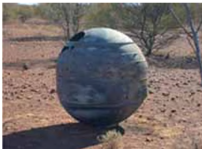
Рис. 3.7. Найденный в Австралии кожух твердотопливного двигателя третьей ступени РН «Дельта-2»
