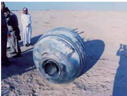
Рис. 3.4. Главный титановый кожух твердотопливного двигателя верхней ступени РН «Дельта» (240 км от Эль-Рияда, 70 кг) [PAM-D Debris..., 2001]
