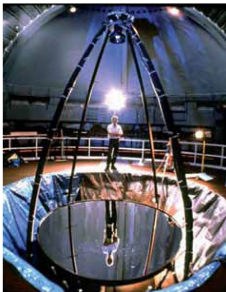
Рис. 1.25. Трехметровый телескоп НАСА с жидким зеркалом
