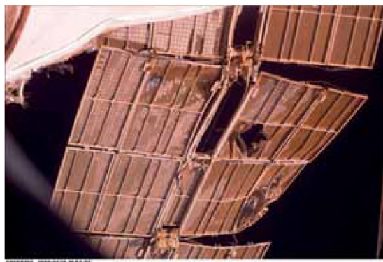
Рис. 3.9. Сильные повреждения солнечных панелей модуля «Спектр» ОС «Мир», полученные в июне 1997 г.
