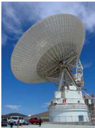
Рис. 1.12. Бистатистическая РЛС «Голдстоун», передающая и приемная антенны
