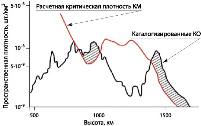
Рис 3.45. Критическая плотность в низкоорбитальной области
