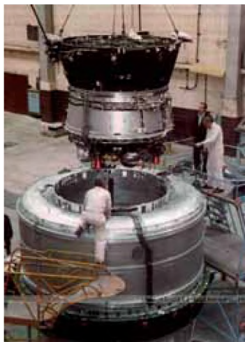
Рис. 3.44. Центральный бак ступени «Бриз-М» и главный двигатель, вставляемый во вспомогательный топливный бак [New Russian..., 2012]
