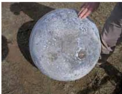
Рис. 3.6. Баллон для сжатого газа от ступени РН «Зенит-3», найденный в штате Колорадо в марте 2011 г.
