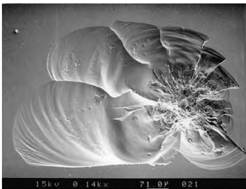
Рис. 3.23. Кратер на иллюминаторе «Шаттл» (миссия STS-50) от удара частицы, выброшенной из сопла ТРД
