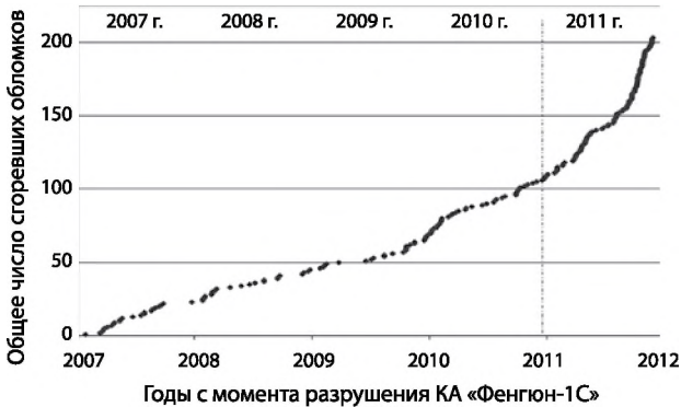
Рис. 1.31. Приблизительно половина сгоревших фрагментов КА «Фенгюн-1С» сгорела за последний год из-за возросшей солнечной активности
