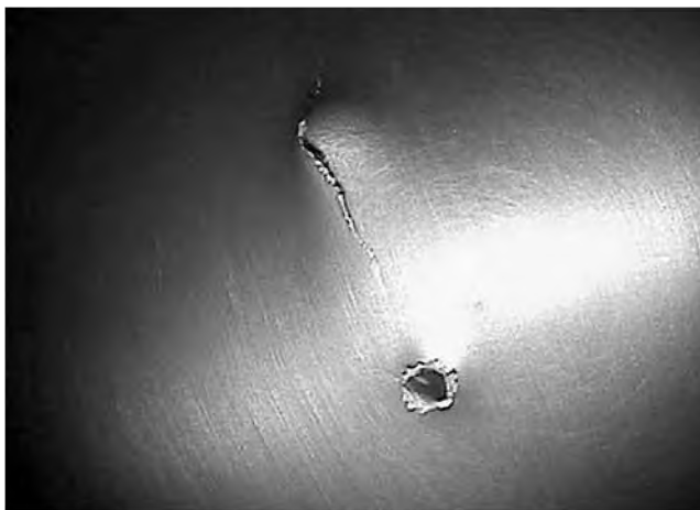
Рис. 3.25. Пробоина и трещина на панели радиатора «Шаттл» миссии STS-115
