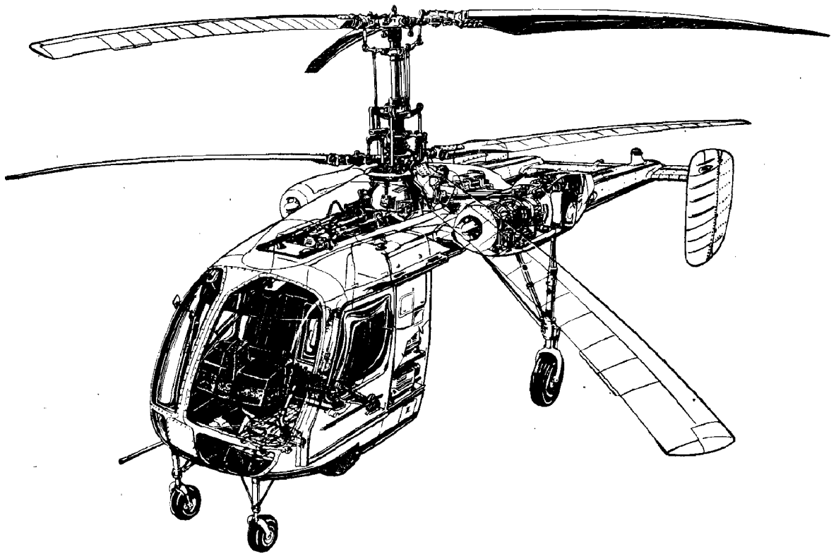
Рис. 2.7 Фюзеляж типа “летающее шасси” вертолета Ка-126.
