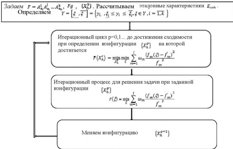
**Рис. 3.1а.** Общая блок-схема алгоритма параметрической идентификации
