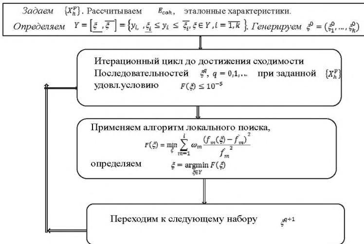
**Рис. 3.1б.** Схема внутреннего итерационного процесса алгоритма параметрической идентификации
