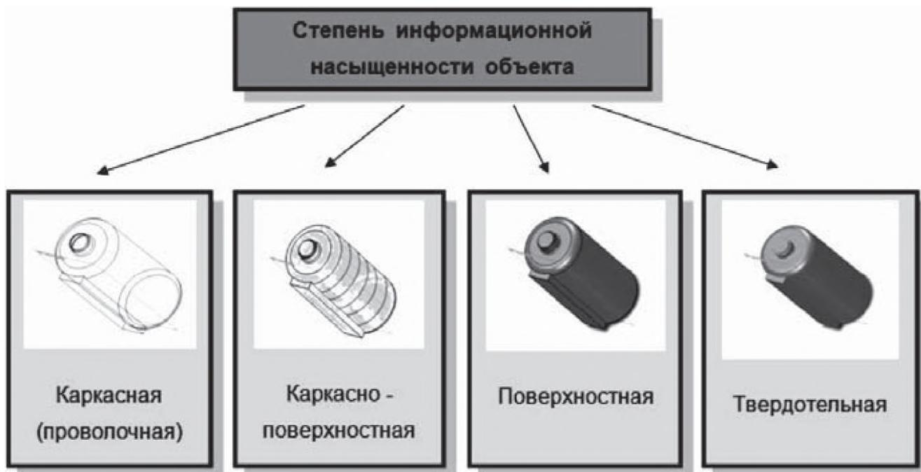
Рис. 3.9. Классификация геометрических моделей по информационной насыщенности
