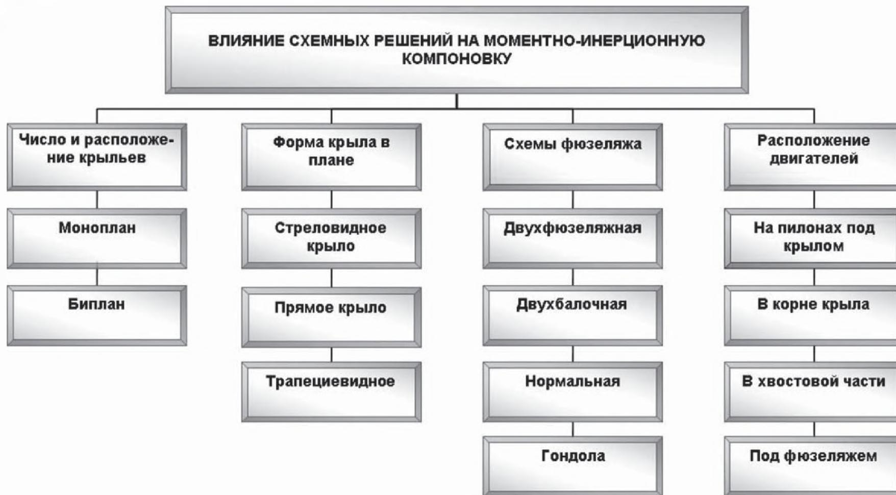
Рис. 5.5. Влияние схемных решений на моментно-инерционную компоновку относительно оси  $Ox$
