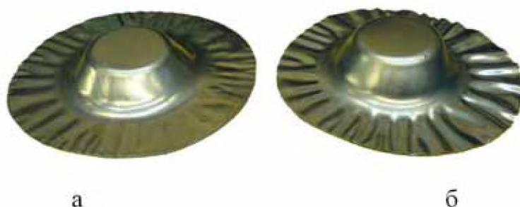
Рис. 9. Заготовка после вытяжки: а — высота 11 мм; б — высота 14 мм
