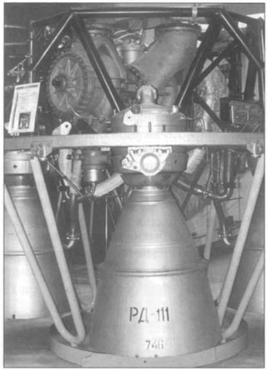
Рис. 7. Двигатель РД-111 для ракеты-носителя Р-9 (тяга около 150 тс)
