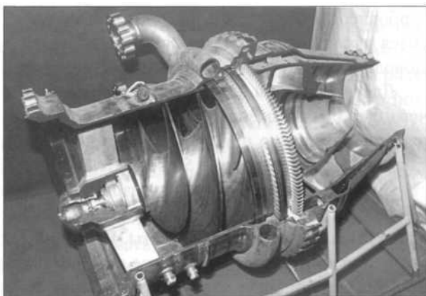
Рис 17. Один из преднасосов ТНА двигателя РД-170(171)
