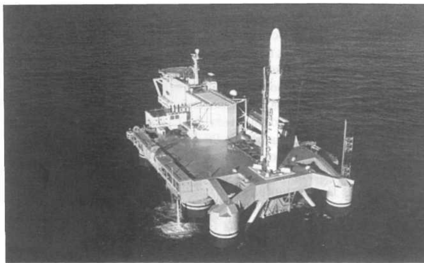
Рис. 24. РН "Зенит-3SL" с двигателями РД-171 и РД-120 стала основой международной программы "Морской старт"
