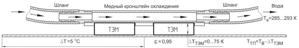
Рис. 6. Схема охлаждения одной тепловой панели экрана
