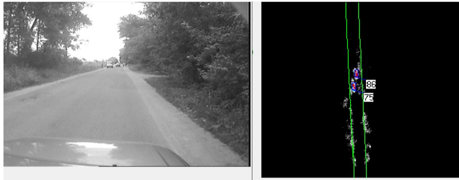
Рисунок 13. Определение дальности до автомобиля в пределах КБ
