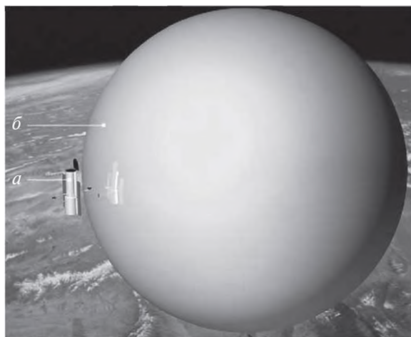
Рис. 11. Аэродинамическое устройство увода КА с рабочей орбиты GOLD по технологии Gossamer Orbit Lowering Device: a — уводимый с орбиты КА; б — надувной баллон (Nock et al., 2010)
