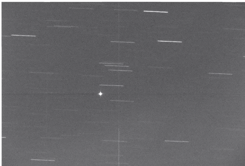
Рис. 4. Снимок объекта на высокоэллиптической орбите при большой угловой скорости движения (телескоп СБГ)
