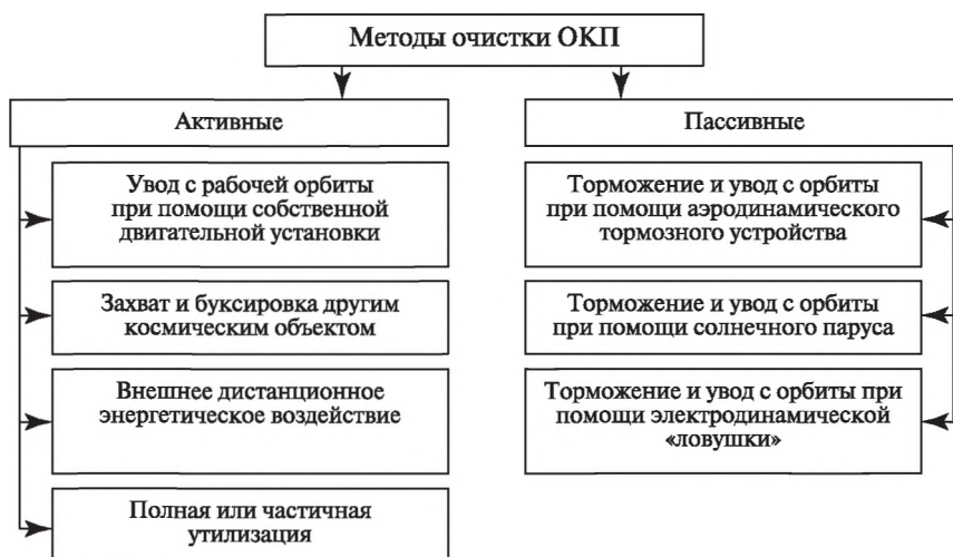
Рис. 1. Классификация методов очистки ОКП от КМ
