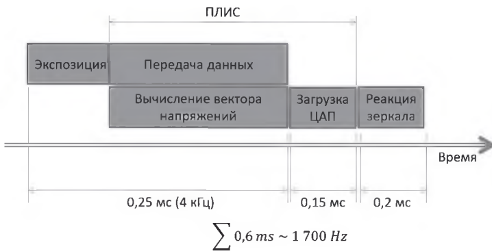
Рис. 6. Временная диаграмма работы системы с ПЛИС
