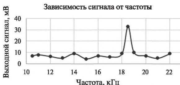
Рис. 4. Амплитудно-частотная характеристика деформируемого зеркала
