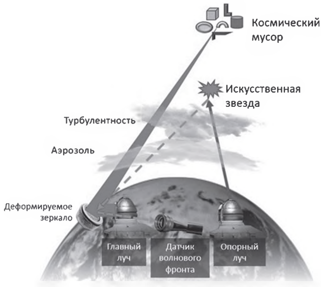
Рис. 1. Использование адаптивной оптической системы в задаче борьбы с космическим мусором
