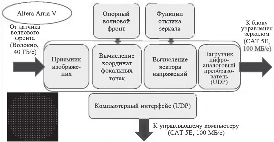
Рис. 5. Функциональная схема ПЛИС в задаче коррекции волнового фронта
