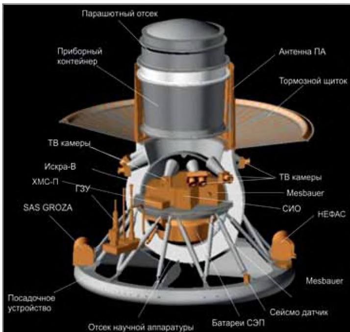
Рис. 1. Предварительная компоновка научной аппаратуры (НПОЛ)
