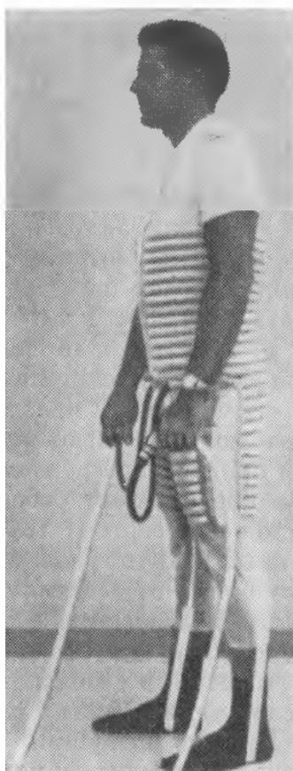
Будущие космические скафандры, возможно, будут обеспечивать защиту космонавта благодаря жестким сегментам, расположенным со стороны спины и на коленях. С помощью выступов на спине скафандр будет крепиться к креслу и таким образом фиксировать положение космонавта на время действия перегрузок.
