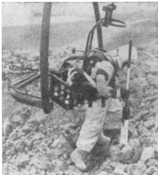
Специальная подвесная система, которая обеспечивает космонавту три степени свободы и снимает  $\frac{5}{6}$  его веса, позволяя тренироваться в ходьбе по имитированному лунному грунту.
