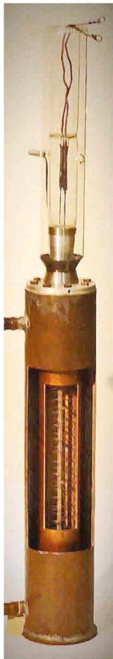
Мощная радиолампа (25 кВт) с охлаждением проточной водой в разрезе
