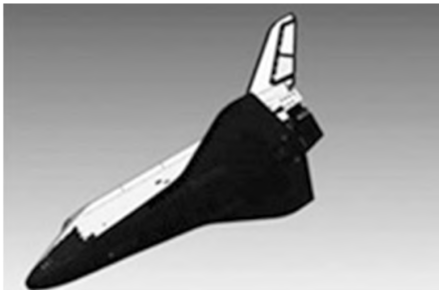
Рис. 35. Начало поворота в положение “киль вниз”
