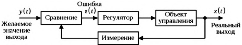
Рис. 22. Замкнутая система управления (с обратной связью)
